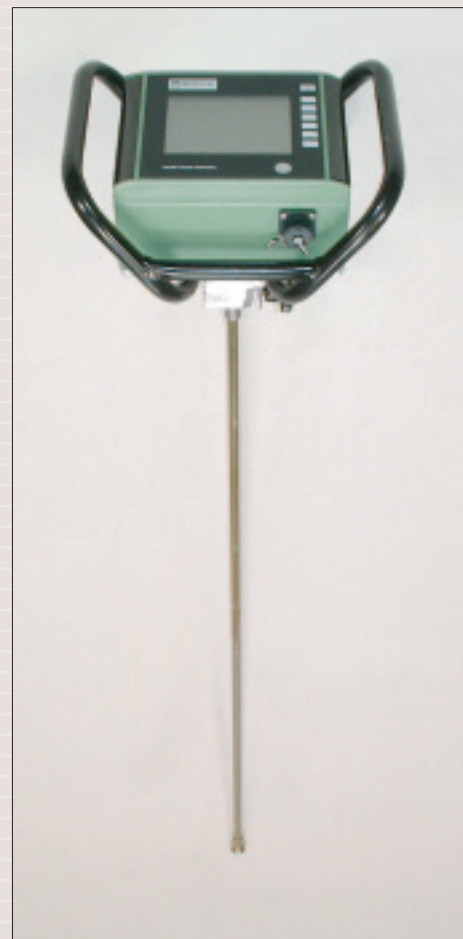
Penetrologger, Sondierstange und Konus
